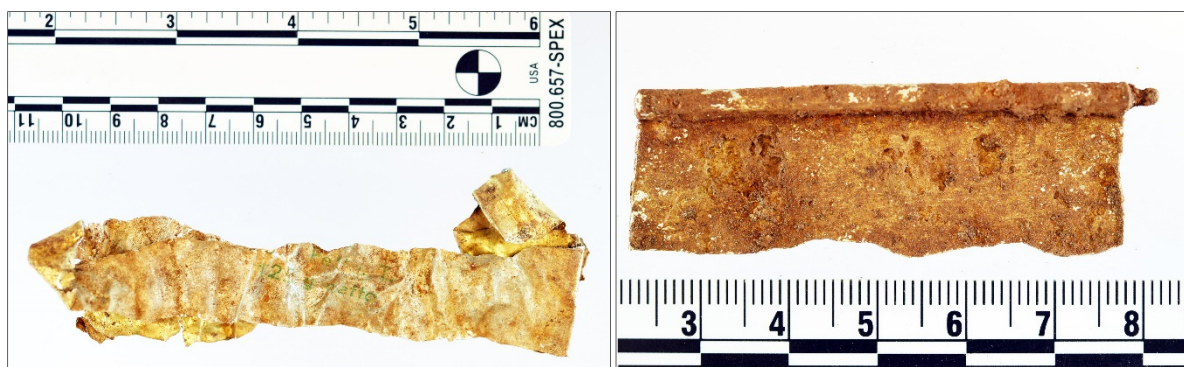
Figur 106. Bearbeidet materiale i aluminiumslegering. Til venstre, F5005, klippet remse fra aluminiumsemballasje, merket med "prosent fett i. T. 125 g netto". Til høyre, F8018, produksjonsmateriale til en hengsel.
