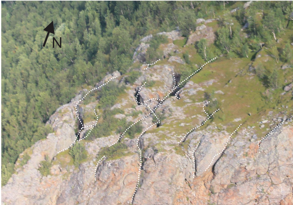
Figur 4-21: Orientering av store åpne sprekker langs benkflaten ved område A.
