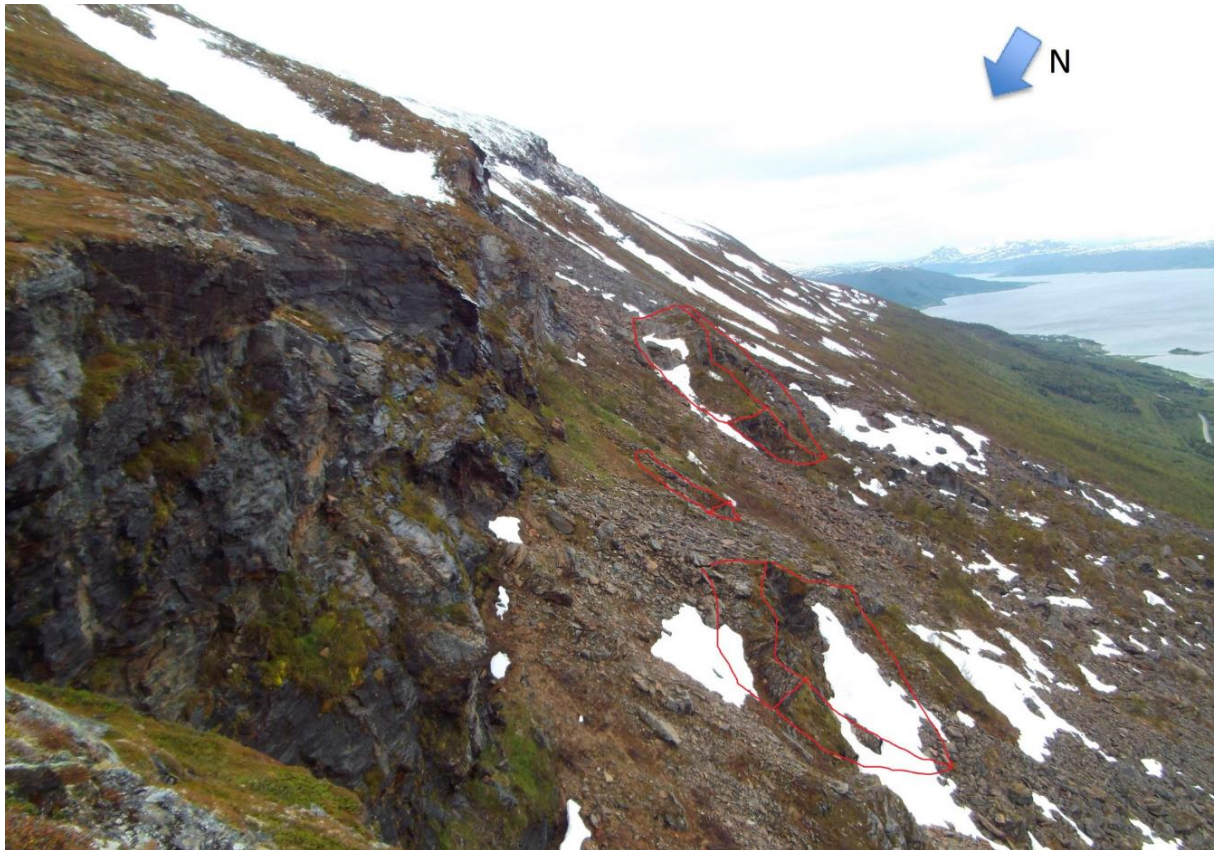
Figur 4-35: Langsgående rygger av delvis intakt berggrunn i skredmassene markert inn med rødt.
