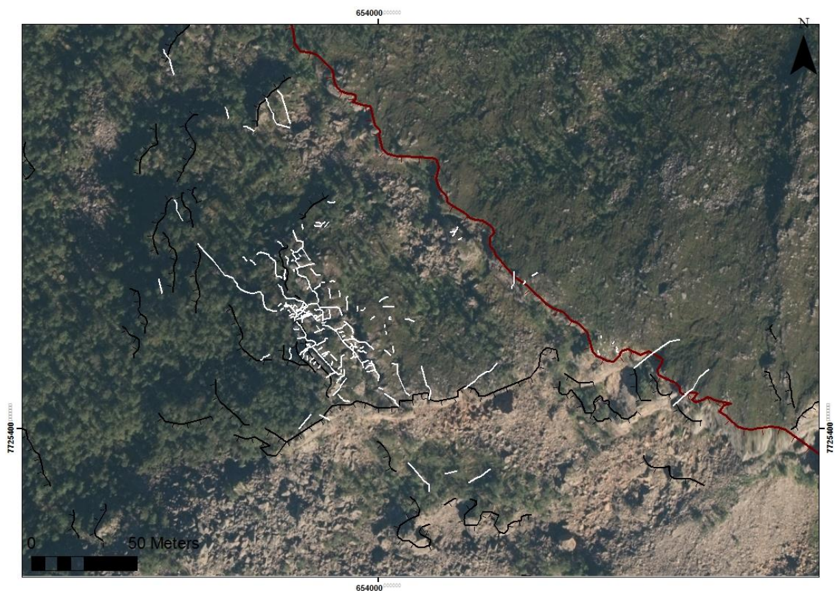
Figur 4-18: Bruddplan ved område A. Hvitt markerer orienteringen av åpne sprekker, sort skrenter mens baskrenten er markert inn med rødt.
