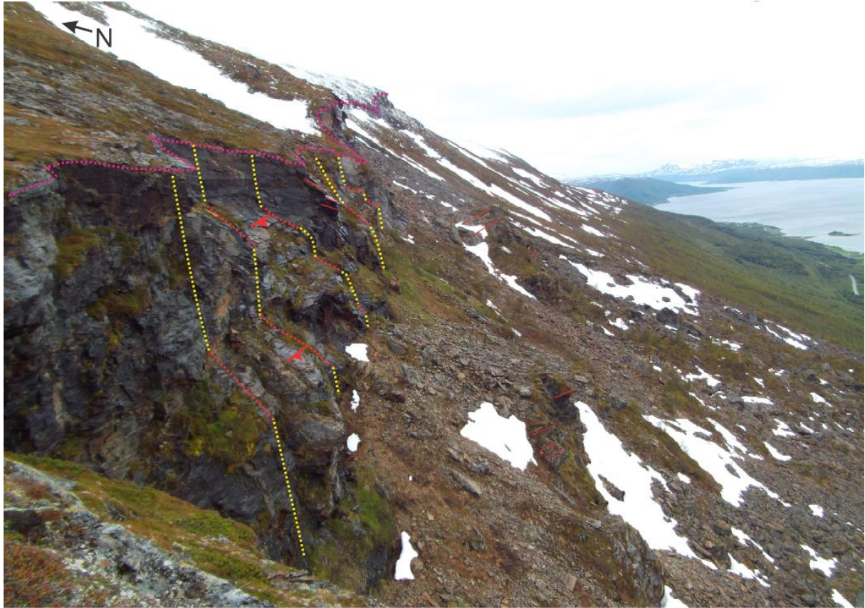
Figur 4-13: Baks-krenten for fjellskredet sett mot SØ. Lilla linje markerer formen på baks-krenten. Rødt markerer foliasjon, gult markerer steile bruddplan/sprekker langs baks-krenten
