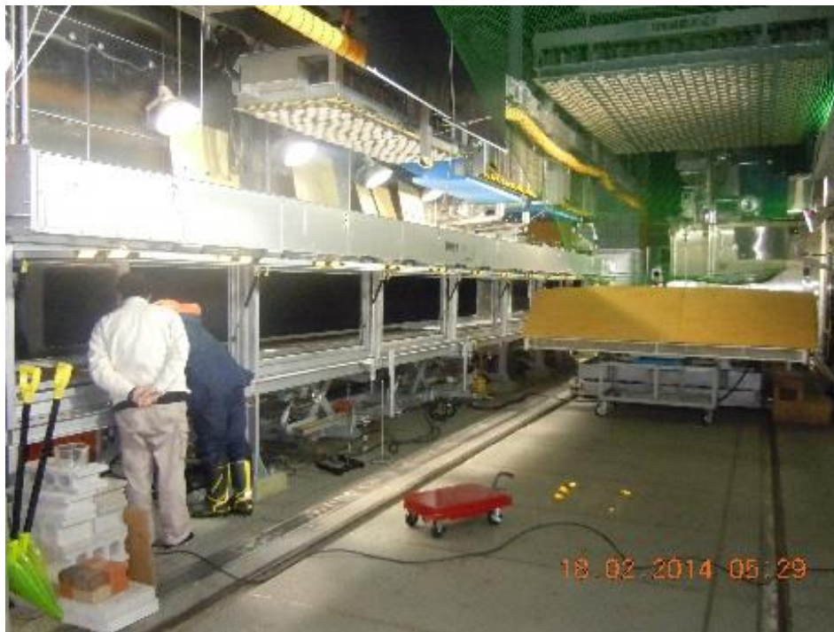
(b). CES Icing Wind Tunnel Test Section
