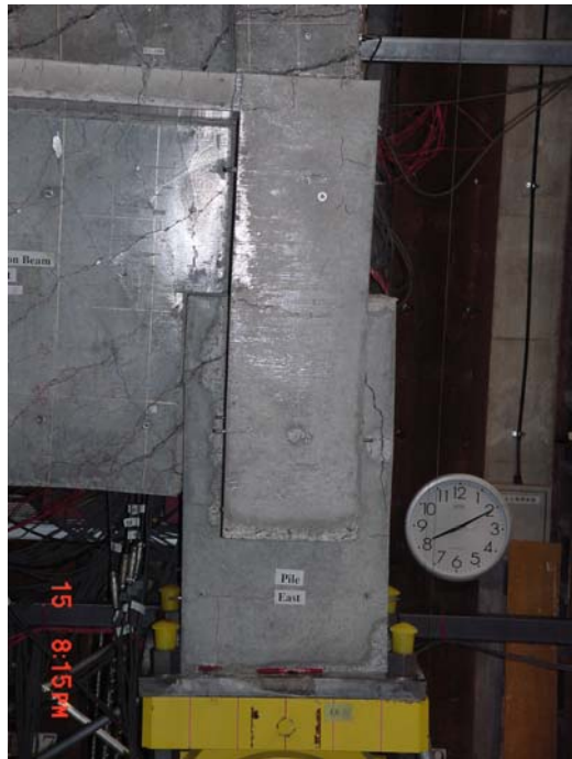
(a) MNWL 試験体の損傷状況 (1F 耐震壁変形角 4.0%) (b) MNWL 試験体の杭頭配筋と回転変形 図 4-27 MNWL 試験体の引張杭、杭頭部の回転変形
