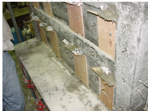
(d) PCW 試験体の目地充填
