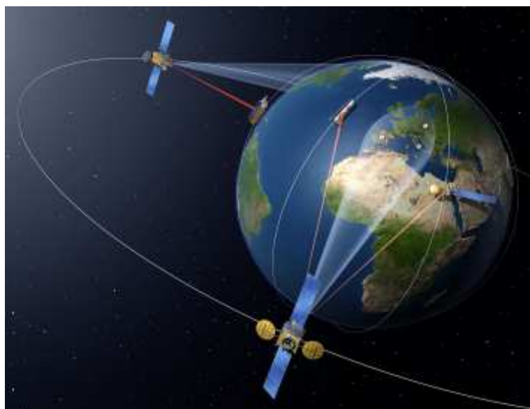
Foto-6: Alphasat i EDRS: dues missions de telecomunicacions de l'ESA. 3 satèl·lits en òrbita geostacionària cobreixen tot el món fins uns 75 graus de latitud.
