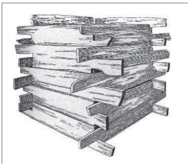
Fig. 21. Esquema del reforç de fusta d'un pou de la ciutat romana de Camulodunum (extret d'Ulrich, 2007).
