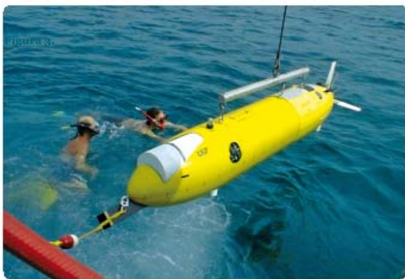
Figura 4. Instal·lació del primer prototipus de SIPPER al vehicle submarí autònom Ocean Explorer, en una campanya realitzada prop de l'illa Lee Stocking a les Bahames. Fotografia de Jim Patten, del Centre de Tecnologia Oceànica de la Universitat de Florida del Sud.
