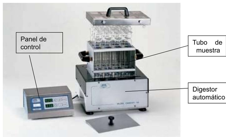
Figura 2: Bloque digestor JPSelecta.
