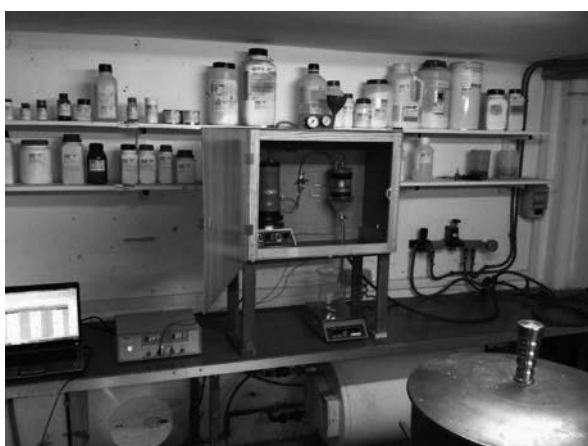
Figura 2. Instalación experimental de electro-filtración.
