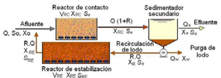
Figura 1. Modalidad de estabilización por contacto
