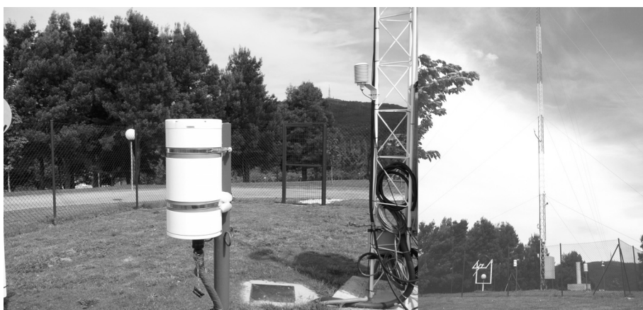
Figura 1. El radiómetro GUV 2511 (a) y su instalación en la Estación de Observación de la Atmósfera de Santiago (b).
