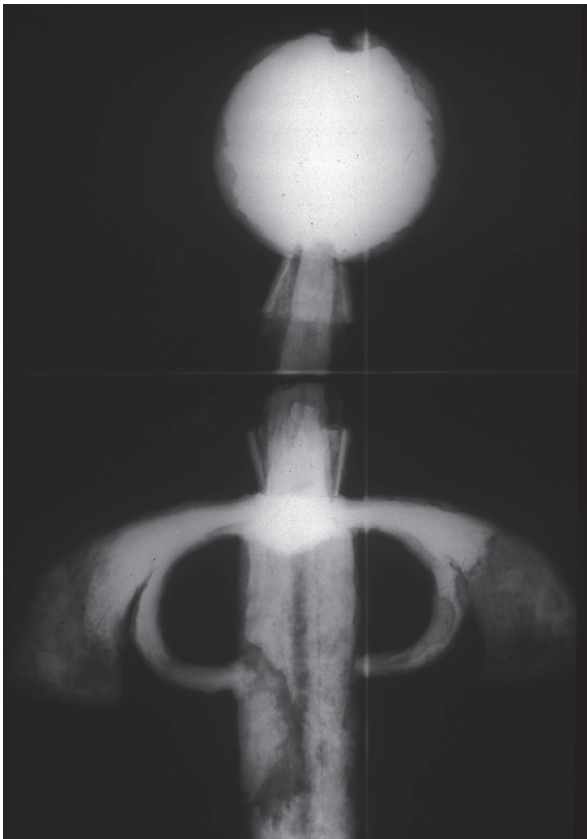
Figura 4. Radiografia de l'empunyadura de l'espasa on es pot veure com l'espiga que surt de la fulla serveix per encaixar els braços, les guarnicions de l'índex i el pom aconseguint, així, donar resistència al conjunt de l'arma. (Dr. Antoni Carceller, Servei d'Oncologia Radioteràpica de l'Hospital Arnau de Vilanova de Lleida.)
