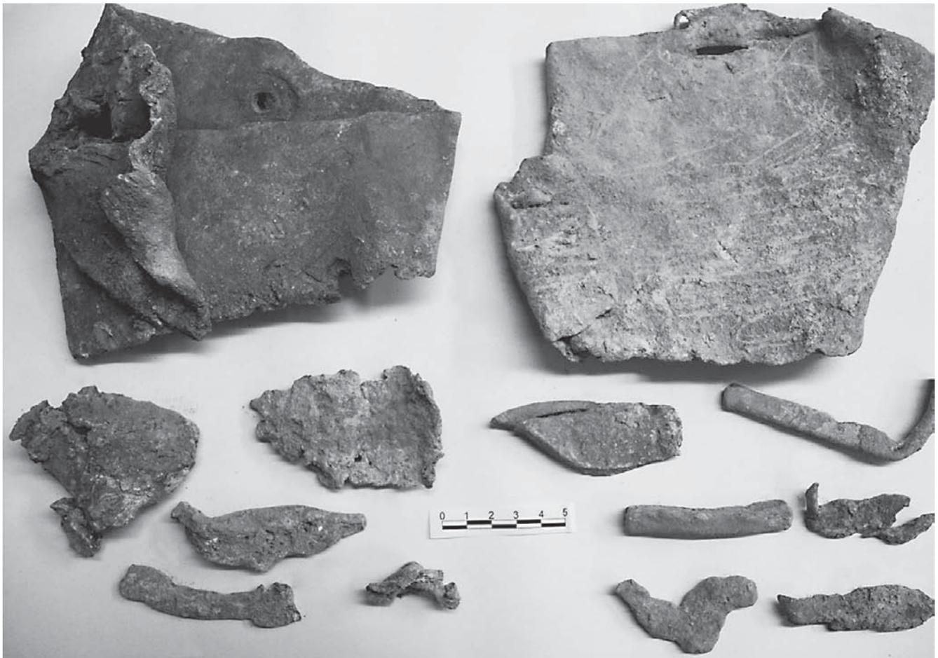
Fig. 46. Fragmentos de láminas y goterones de plomo procedentes de la factoría metalúrgica del parking de Empúries (foto: MAC-Empúries).
