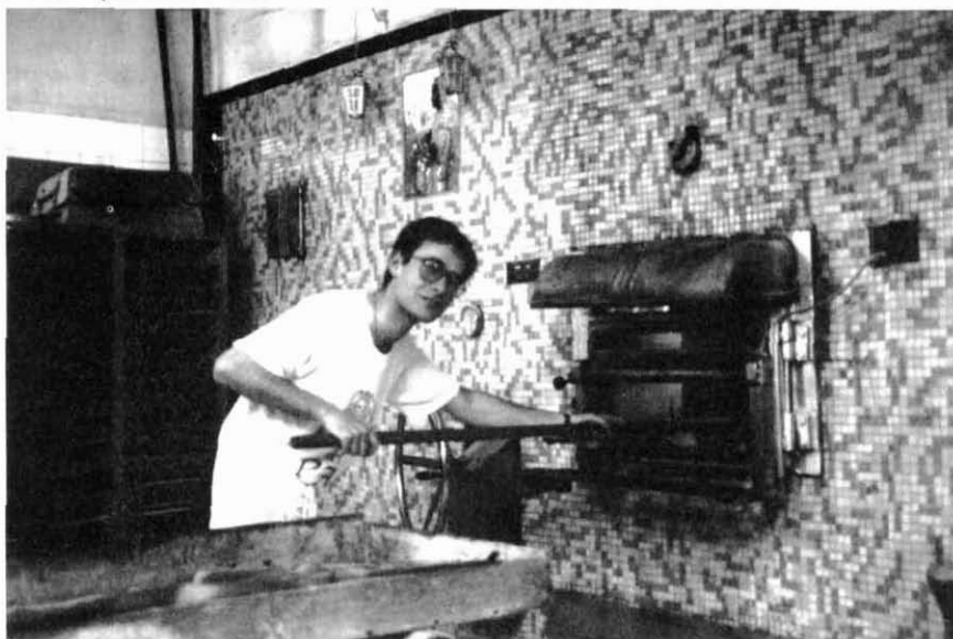
El forn que apareix a la fotografia és de l'any 1962, el tercer construït a Can Girabal. És un forn circular, giratori i amb lloses de ciment refractari.
