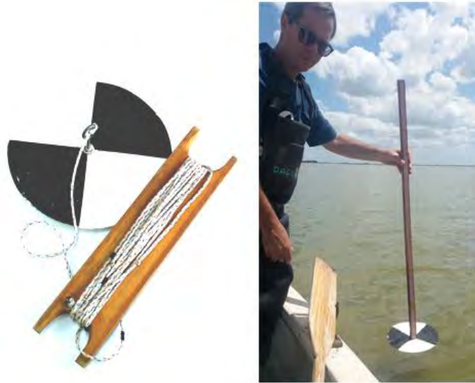
Figura 7. Disco de Secchi comúnmente utilizado en estudios limnológicos y una adaptación del mismo para determinar transparencia en lagunas de alta turbidez del agua.
