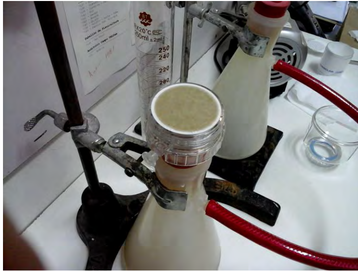
Figura 18. Equipamiento empleado para la determinación de clorofila-a mediante filtros específicos.
