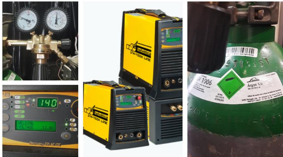
Figura 14. Equipamento de Soldadura TIG com destaque no gás de proteção; visor com informações de corrente e tensão elétrica – Laboratório de Tecnologia Mecânica (IPB).
