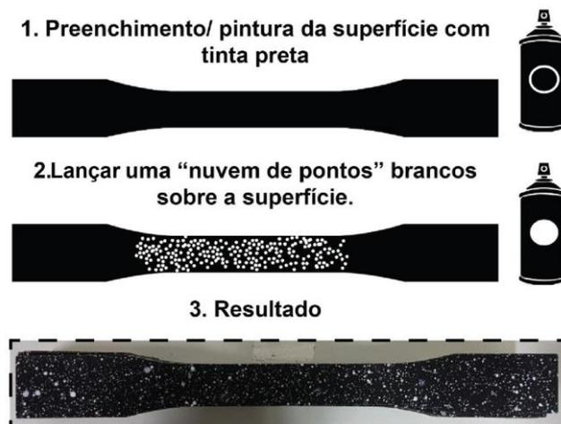
Figura 22: Preparação dos provetes para correlação digital de imagens: foi aplicada uma base preta com a sobreposição de uma nuvem de pontos branca.
