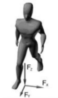
Figura 42- -Sistema de eixos das componentes da ação que o peão provoca sobre a estrutura (Pimenta, 2008).
