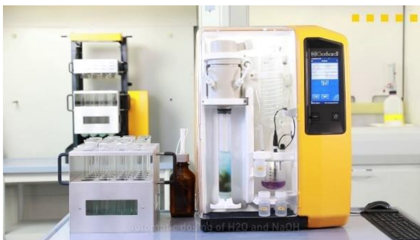
Figura 3.3: Equipamento Kjeldatherm/Vapodest para digestão, destilação e titulação utilizado para a determinação do teor de proteína da carne
