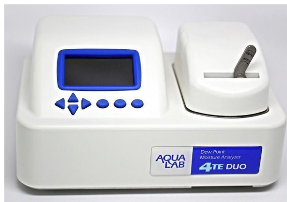
Figura 3.5: Analisador AquaLab utilizado para a medição de atividade da água da carne
