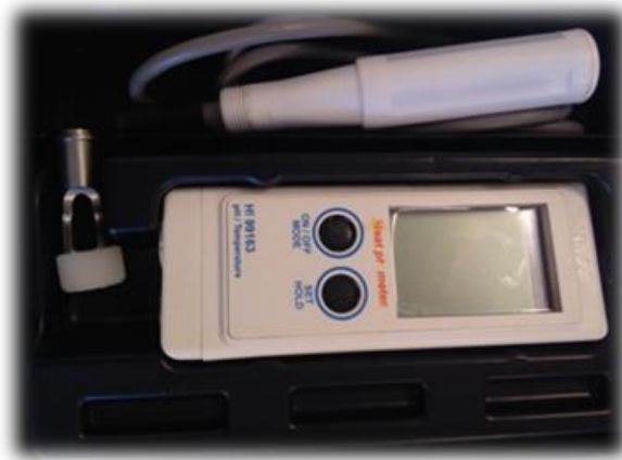
Figura 3.4: Potenciómetro Hanna HI 99163 utilizado para a medição de pH da carne
