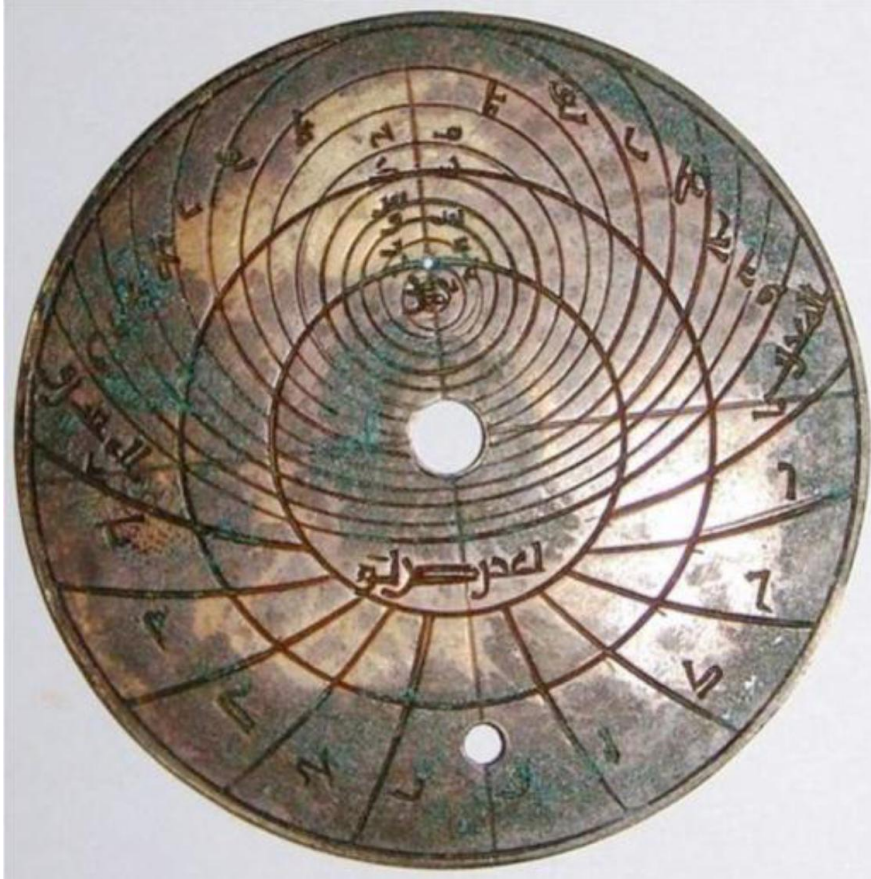
Fig. B3: The plate for latitude 36°.
