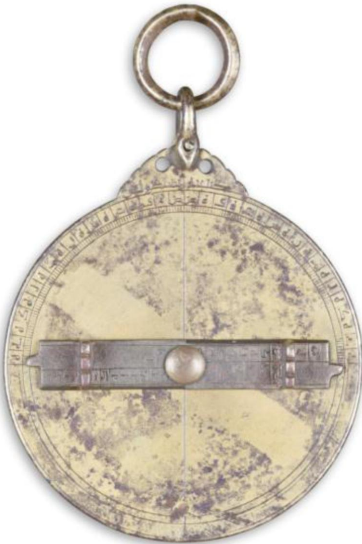
Fig. A2: The back with the alidade.
