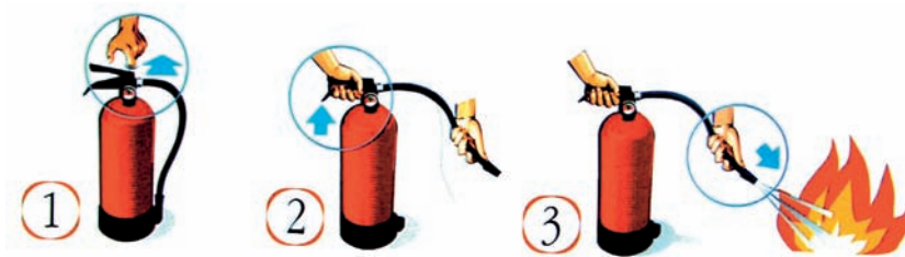
Figura 3. Protocolo de utilización de un extintor.
