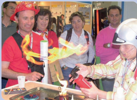
Figura 7. Expansión de llamas al añadir agua a un fuego simulado de tipo F.
