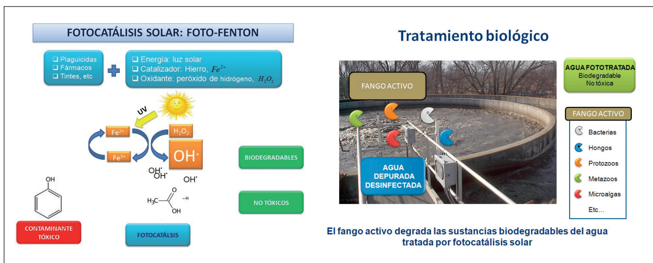
Figura 3. Procesos de biodegradación por fotocátalisis solar y fango activo del proyecto FOTOMEM.
