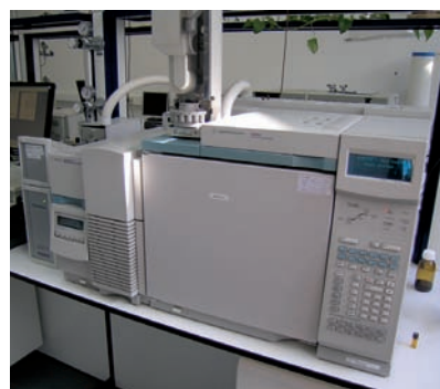
Figura 8. Cromatògraf de gasos acoblat amb espectrometria de masses (CG-MS) utilitzat a l'empresa Solvay.
