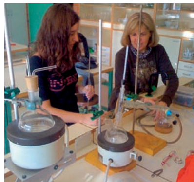
Figura 6. Al laboratori de química de l'institut realitzant el muntatge de la destil·lació per arrossegament de vapor.
