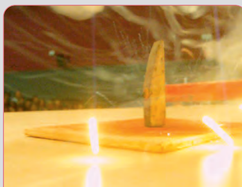
Figura 6. Reacció entre el fòsfor vermell i el clorat de potassi iniciada per pressió.
