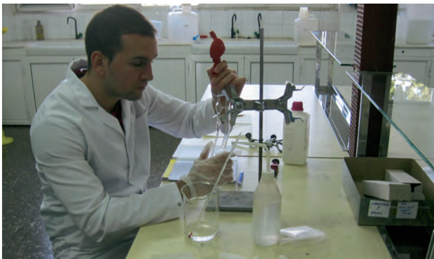
Figura 16. Alumne realitzant una mesura de viscositat amb Cannon-Fenske sense ulleres i només amb un quant.
