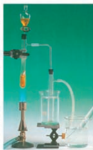
Rys. 12.6. Ogrzewanie oleju napędowego bez selata prowadzi do powstania benzyny i gazów lotnych.
