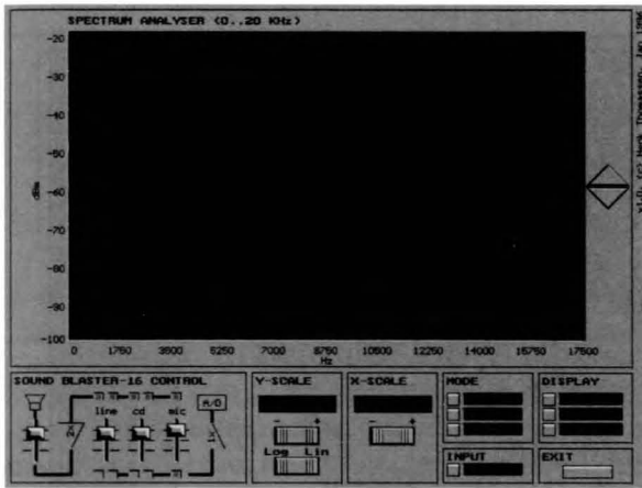
Figura 3. Analizador de espectros virtual. La señal de entrada se ha obtenido acercando el micrófono al altavoz de agudos. Se observa el pico a 2358 Hz correspondiente a la frecuencia fundamental así como 6 de los armónicos.
