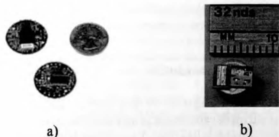
Figura 7: distintos tipos de sensores con capacidad de transmisión de datos por interfaz radio: a) sensores MICA2DOT de Crossbow [26] y b) sensor de Smart Dust
