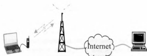
Figura 1. Esquema de una conexión a Internet mediante un terminal móvil
