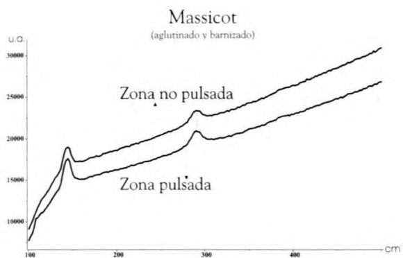
Figura 16. Espectro superior: zona no pulsada de la muestra (tiempo de adquisición de 20 seg); espectro inferior: zona pulsada, barniz ablacionado (tiempo de adquisición de 30 seg).
