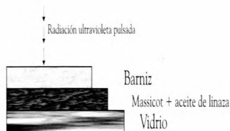
Figura 6. Muestra preparada para la limpieza de barniz con luz ultravioleta pulsada.
