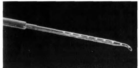
**Figura 3.-** Haz de 16 electrodos. Pueden configurarse como 15 electrodos monopolares, actuando uno de ellos como referencia, o como 8 electrodos bipolares. Los cables que conectan a cada uno de los electrodos están recubiertos de un material aislante y biocompatible. Cada bolita constituye un electrodo, y éstos sobresalen de la funda aislante para establecer contacto con la cóclea.
