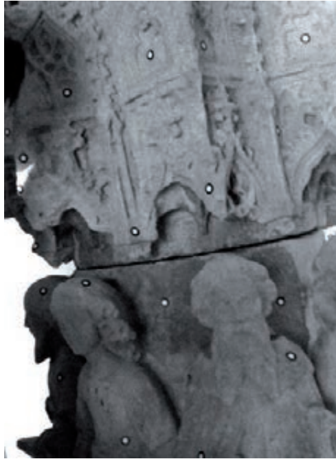
Figura 4. Marques utilitzades per a la unió dels diferents escanejats. Imatge cedida per l'empresa Nub3D.
