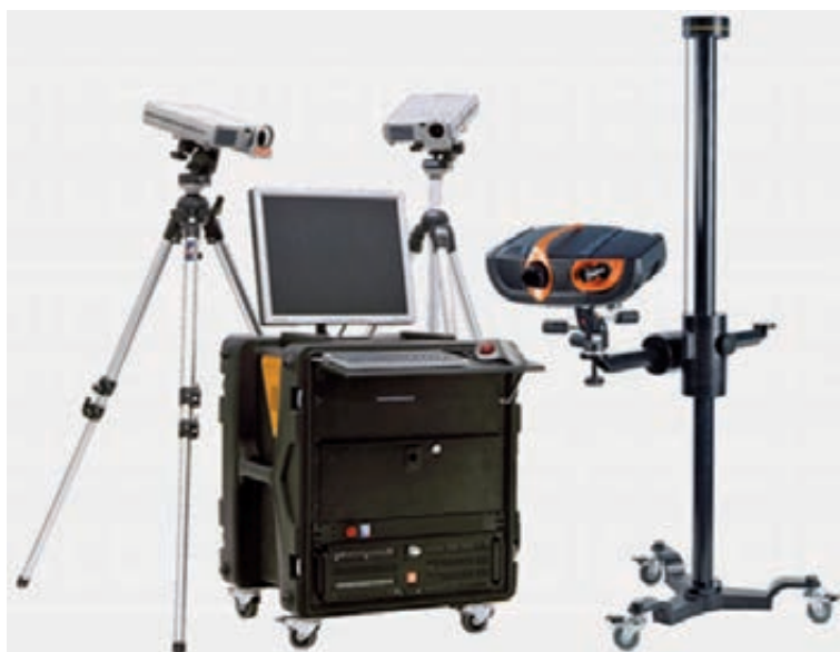
Figura 3. Escàner Nub3D. Imatge cedida per l'empresa Nub3D.
