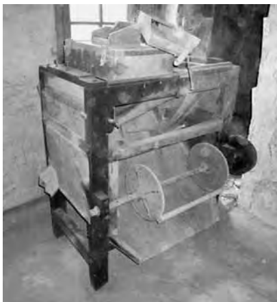
Estat actual de l'espellofadora. (Falta el mecanisme que sacseja la safata perforada).
