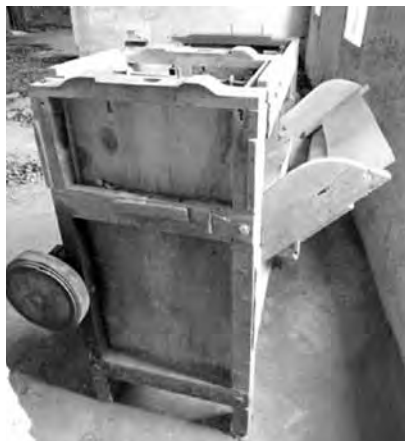
Estat actual de l'espellofadora. (Falta el mecanisme que sacseja la safata perforada).
