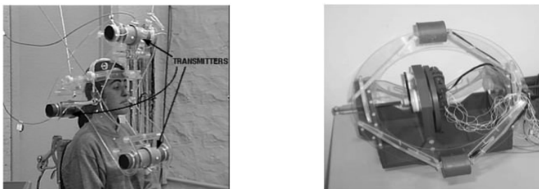
Figura 1. Casco y transmisores del sistema EMMA de Haskins (izquierda) y del AG100 de Carstens (derecha).
