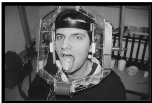
Figura 3. Disposición de los receptores en los diferentes articuladores (sistema AG100).
