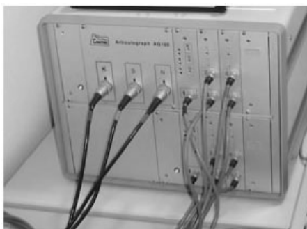
Figura 2. Caja EMA correspondiente al sistema AG100 de Carstens.
