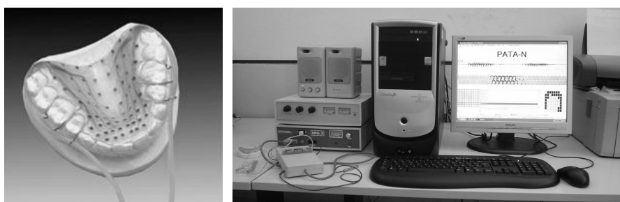
Figura 1. Componentes del EPG WinEPG de Articulate Instruments Ltd. en el Laboratori de Fonètica de la UB.
