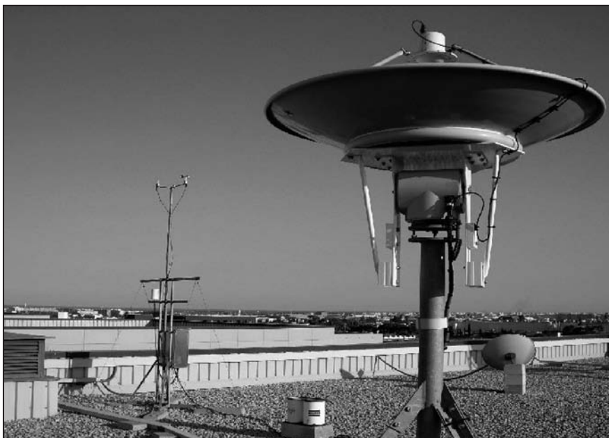
Figura 1. Observatorio meteorológico y estación automática de meteorología de la Universitat Jaume I. En primer término antena para la recepción de satélites polares (Dartcom HRPT).
