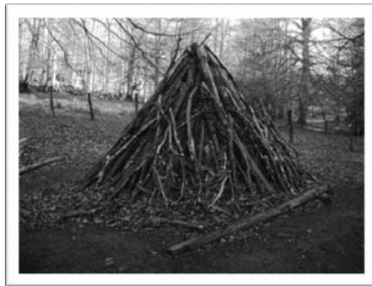
FIGURA 4. Preparativos para configurar la carbonera.
