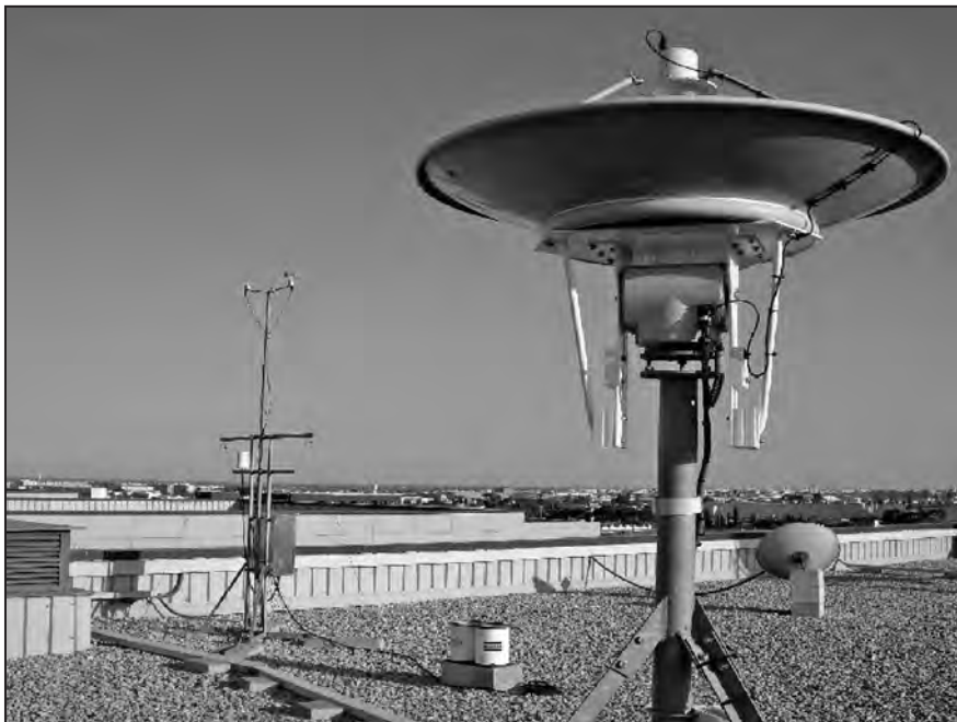
FIGURA 1. Observatorio meteorológico y estación automática de meteorología de la Universitat Jaume I. En primer término antena para la recepción de satélites polares (Dartcom HRPT).
