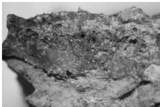
Figura 6. Detall de la secció d'un gresol de Minferri. Presenta components metàl·lics distribuïts de manera irregular (Clixé I. Montero, 10x).
