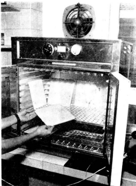
Figura 6. — Secado de la placa a 120° C durante 20 ó 30 minutos, a 70° C durante 2 horas.
