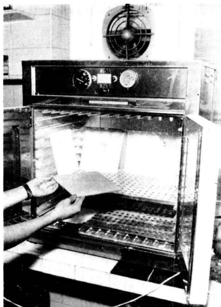
Figura 2. — Las placas preparadas se activan en la estufa de desecación a 120° C durante 20 ó 30 minutos.
