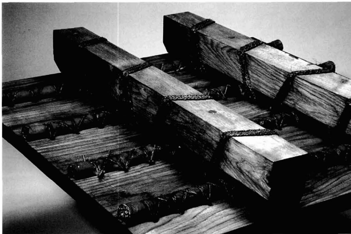
Figura 3. Modèle d'étude, à l'échelle 1, d'une section du navire romain de Comacchio (réalisation S. Marlier, R. Roman, CNRS/CCJ) (photo: Ch. Durand, CNRS/CCJ).
