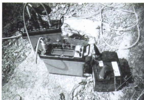
Figura 2. Sistema de adquisición de información (ABEM – Terrameter SAS – 4000) empleado en las prospecciones geofísicas. El dispositivo se conecta a 64 electrodos de acero inoxidable que se clavan en el suelo y se unen con dos cables blindados para evitar los efectos de inducción.
