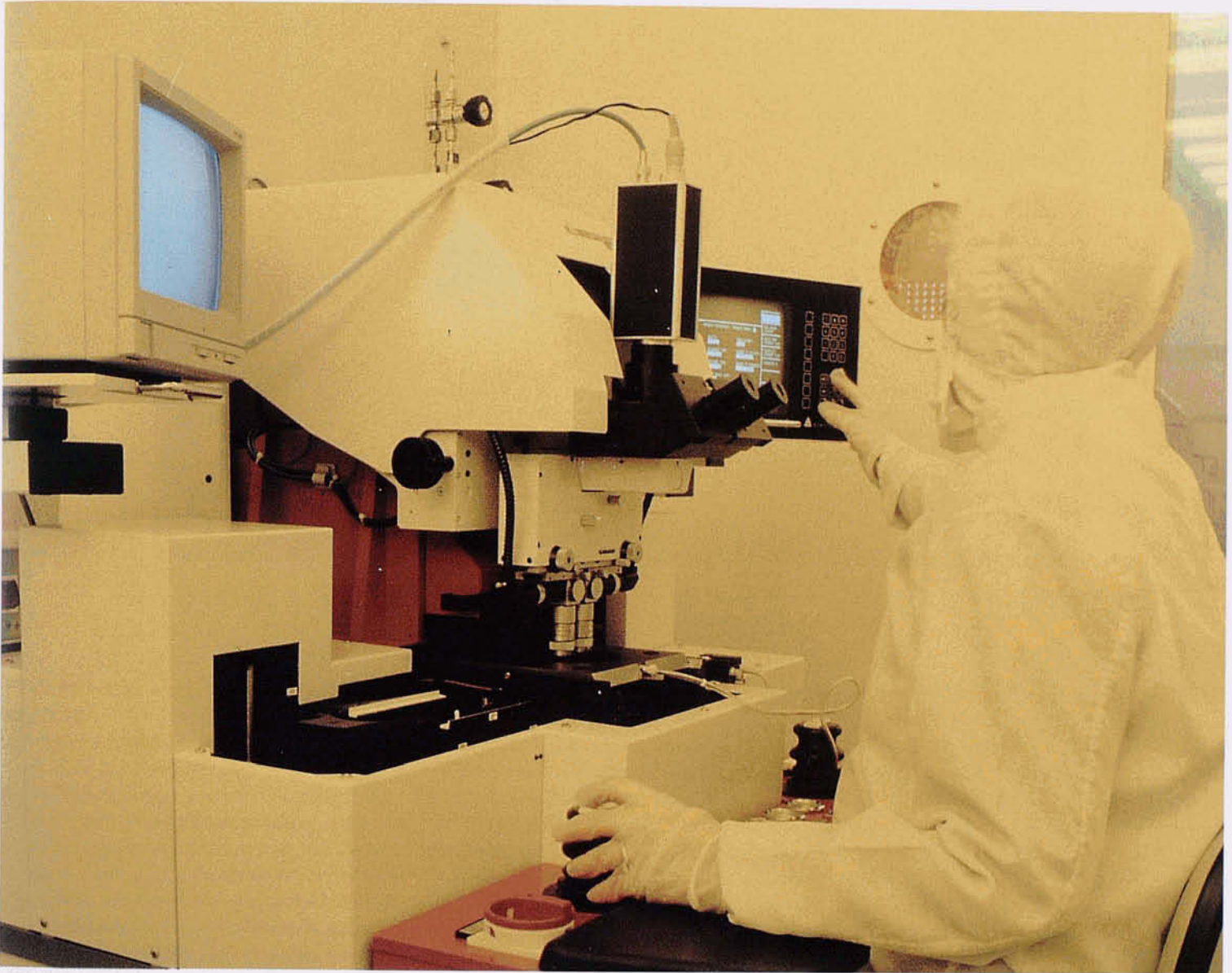
FOTOLITHOGRAPHISCHE ANLAGE IN EINEM REINRAUM
