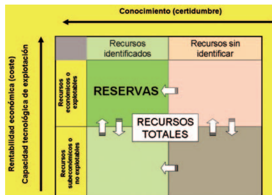
Fig. 12. La caja de McKelvey (simplificada en la imagen) representa el reparto de un recurso no renovable (por ejemplo recursos minerales) en función del grado de conocimiento sobre su existencia y su explotabilidad (por razones tecnológicas, legales o económicas).
