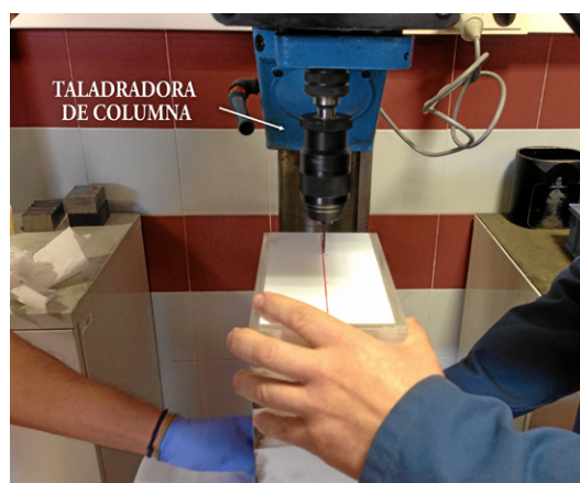
Fig. 5. Proceso de elaboración de la conexión para los piezómetros: taladros.
