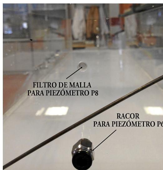
Fig. 6. Detalle de los piezómetros: racores y filtros de malla.
