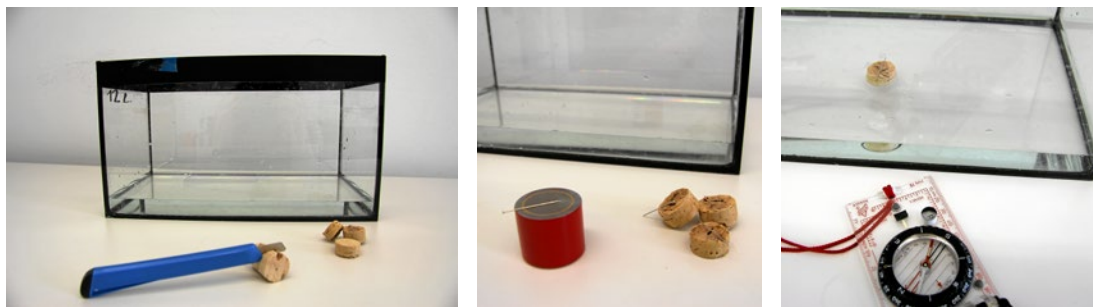
Fig. 3: a. Cortando los corchos con un centímetro de espesor. b. Frotando los alfileres para magnetizarlos. c. El alfiler encima del corcho se orienta con el dipolo magnético, comprobado con la brújula.
