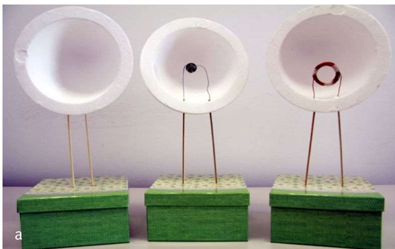
Fig. 6: a. Entrañas de las maquetas, la primera vacía, segunda con un imán y tercera con una bobina conectada con la caja (se colocará horizontal antes de cerrarla). b. Circuito colocado en la caja (menos la bobina). c. Pasando el magnaprobe por una de las maquetas para observar si hay un campo magnético.
