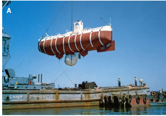
Fig.6. Los batiscafos. A. El batiscafo italiano- americano Trieste. B. El batiscafo francés Archimède.
