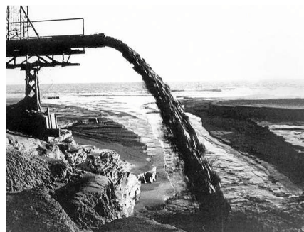
Fig. 1. Punto de vertido al mar de los residuos mineros procedentes del Lavadero Roberto.
