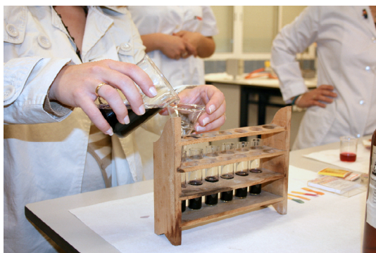
Fig. 2. Preparación de la experiencia. Tubos con el indicador (caldo de lombarda), se muestra el pH del caldo de lombarda pH= 7.
