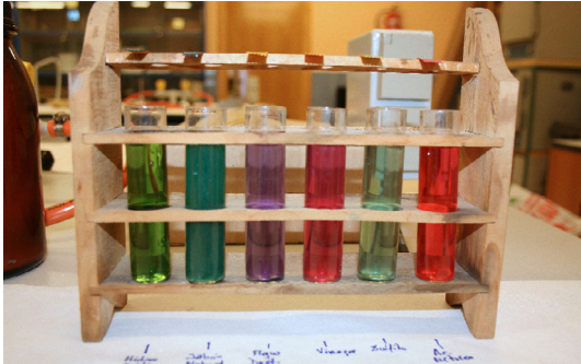
Fig. 3. Tubos de ensayo con el resultado de la experiencia. Se ve como el color rojo corresponde a las disoluciones de ácido, y el verde a las de bases. En el centro el tubo control, con agua destilada de color azul-violeta.
