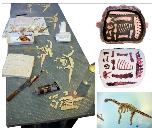
Fig. 4. Resulta conveniente preparar moldes de las piezas que se emplearán en los talleres para poder realizar tantas réplicas como sea necesario. A la derecha, molde de silicona sobre piezas de plastilina.
